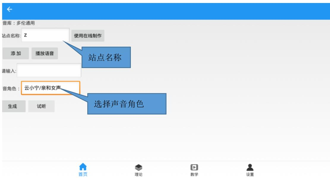
使用在线制作时，先输入站点名称，然后把需要播报的内容输入到输入框里，选择合适的朗读者，点击生成，再点试听，然后再点添加。
