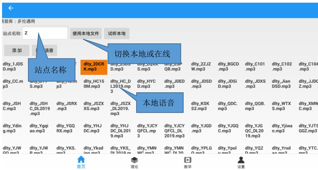
使用本地文件时，先将机器连上电脑，将文件复制 kbsdata\mp3\文件夹里。然后可以从列表里找到文件，点试听本地，确认正确语音后，输入站点名称后点添加。
